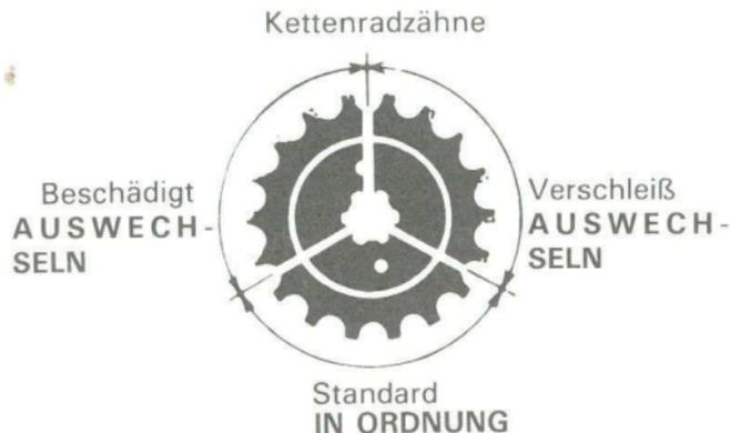
5. Falls Antriebskette oder Kettenräder übermäßig verschlissen oder beschädigt sind, müssen sie ausgewechselt werden. Niemals eine neue Kette auf verschlissene Kettenräder montieren, weil dies zu schnellem Verschleiß der neuen Kette führt.
